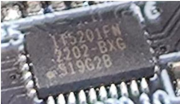
Imagem 4 – Componente da PCBA - Posições U2605 e U2702 (Um CI para cada par de portas USB)
